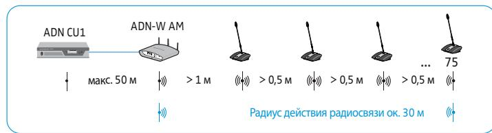
Радиус действия радиосвязи антенного модуля и беспроводных действий составляет около 30 м. В зависимости от окружения или особенностей помещения, радиус действия может варьироваться.
